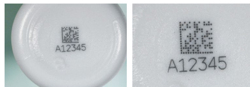
Znacznik o wysokim kontraście wykonany laserem ultrafioletowym na butelce HDPE
