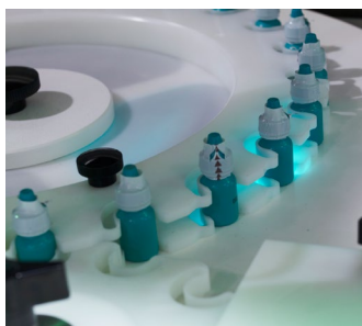
Koło gwiazdowe do przenoszenia butelek zapewniające aktywną kontrolę podczas znakowania
